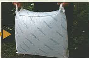
約2分後に約20kgの土嚢が完成
