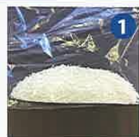
約2分後に約20kgの土嚢が完成
