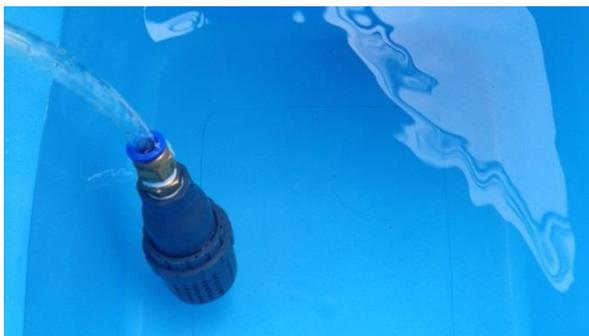
呼び水ポンプの透明ホースを呼び水口に差し込みます。
