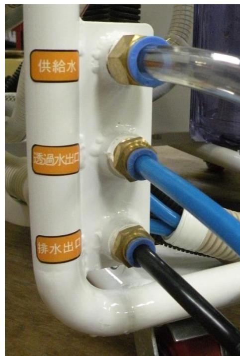
**供給水・透過水・排水各ホースの接続方法** 各ホースは、接続口へ止まるまで差し込むだけで完了です。
