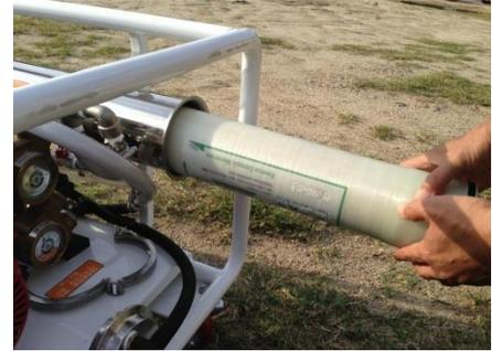
前処理・後処理フィルターを取付けます。
