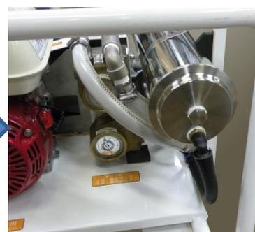
※逆浸透膜には、挿入する方向があります。表面に記載している矢印の方向に向けて挿入して下さい。
